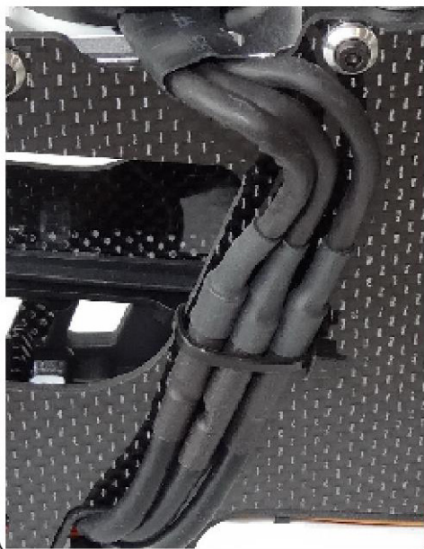
Fig. 1 zeigt die korrekte Verkabelung der Phasenkabel (Kabel von Regler zum Motor)
