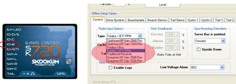
Da das Gerät werksseitig für die Verwendung von Spektrum/JR Satelliten eingestellt wurde müssen Sie es umstellen, damit ein PPM Empfänger benutzt werden kann. Dies können Sie in der PC Software einstellen. Verwenden Sie dazu den Initial Setup Wizard und folgen Sie dessen Anweisungen.
