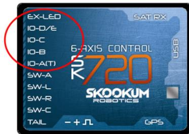
Der elektronische Drehzahlregler oder das Gas Servo sollte an IO-A(T) angeschlossen werden. Jegliche Zusatzfunktion (Fahrwerk, Landelichter,...) werden an IO-B, IO-C, IO-D oder IO-E angeschlossen. Schließen Sie die SK720 LED an den Anschluss EX-LED an.
