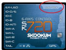
Wenn das SK720 ausgeschaltet ist, können Sie die Satelliten an der Seite des Gerätes anschließen. Standardmäßig ist das Gerät für die Verwendung von Spektrum/JR Satelliten voreingestellt. Wenn Sie einen Graupner empfänger verwenden möchten, müssen Sie das SK720 dafür umstellen. Dies können Sie in der PC Software machen, folgen Sie dazu den Anweisungen des „Setup Wizard“.
