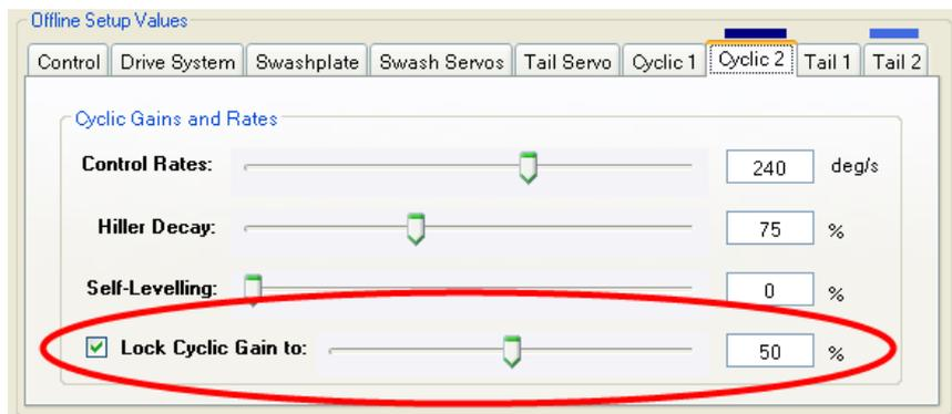
Sie können der Empfindlichkeit auch einen fixen Wert zuweisen. Dies können Sie machen, indem Sie bei „Lock Cyclic Gain“ den Hacken setzen wie im oberen Bild zu sehen. Der Wert kann über den Schieberegler oder die Tastatur eingestellt werden.
