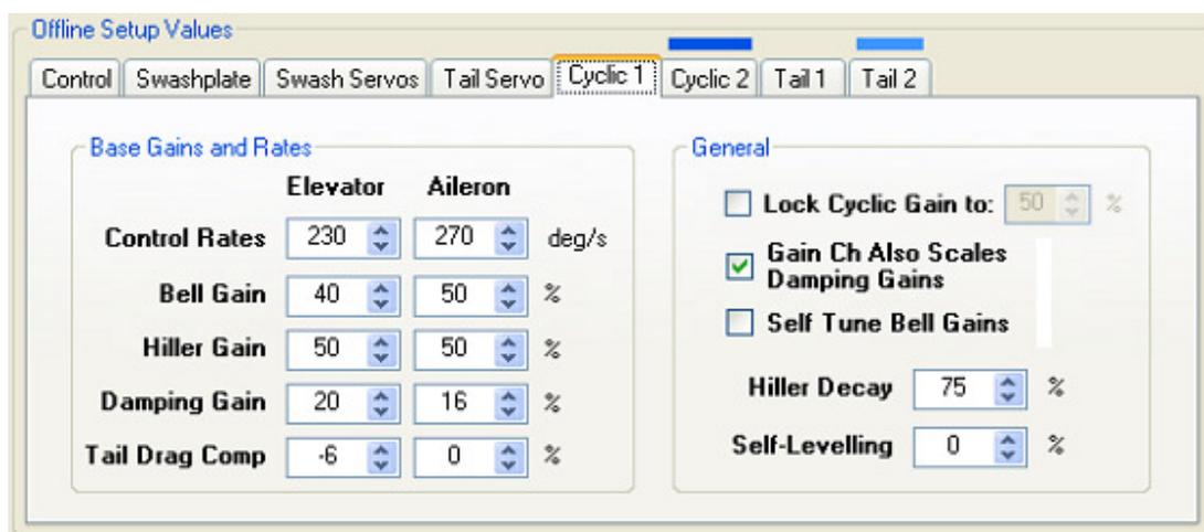
**Control Rates:** Ermöglicht es die maximale Roll oder Pitch Rate einzustellen. Diese Einstellung hat denselben Effekt, wie das Verändern der Fläche bei Paddeln.
