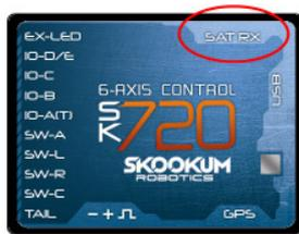
Da das Gerät werksseitig für die Verwendung von Spektrum/JR Satelliten eingestellt wurde müssen Sie es umstellen, damit ein S-BUS Empfänger benutzt werden kann. Dies können Sie in der PC Software einstellen. Verwenden Sie dazu den Initial Setup Wizard und folgen Sie dessen Anweisungen.
