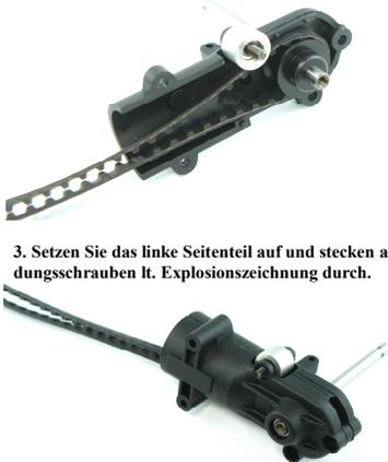
3. Setzen Sie das linke Seitenteil auf und stecken alle M3 Verbindungsschrauben lt. Explosionszeichnung durch.
