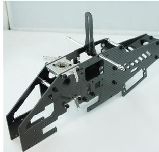
Das linke Seitenteil kann nun aufgesetzt und verschraubt werden. Dabei sollte die Rotorwelle immer noch eingeschoben sein.
