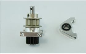
Der Heckantrieb wird laut Abbildung aus den entsprechenden Teile zusammengesetzt. Das Riemenrad 13 wird soweit aufgeschoben bis das Gewinde der Madenschraube deckungsgleich mit der unteren Sackbohrung der Welle liegt und anschließend mit den Madenschrauben M3x3 gesichert.
