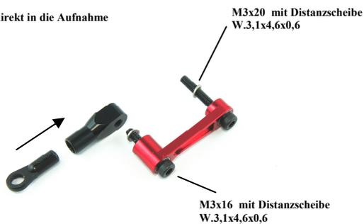
Die Mitnehmerarme werden jeweils mit den passenden Schraubenlängen lt. Explosionszeichnung ausgerüstet und mit den Distanzscheiben 16 (W.3,1x4,6x0,6) versehen.
