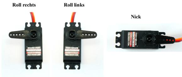
Montieren Sie die mit Hebeln ausgestatteten Servos in ihre jeweilige Endposition. Verwenden Sie dazu die entsprechenden Schrauben M2,6x10 und Auflageplättchen 3. Es ist ratsam die den Servos beiliegenden Gummifülln zu verwenden, es müssen jedoch keine Messinghülsen verwendet werden.
