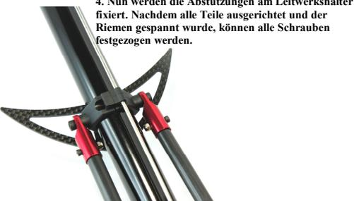
4. Nun werden die Abstützungen am Leitwerkshalter fixiert. Nachdem alle Teile ausgerichtet und der Riemen gespannt wurde, können alle Schrauben festgezogen werden.
