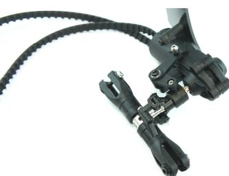
Verbinden Sie die Anlenksegmente des Tail Pitch Sliders 13 unter Zuhilfenahme der Messinghülsen und Schrauben mit den Blatthaltern. Achten Sie dabei auf die korrekte Laufrichtung. Sie Detail E.
