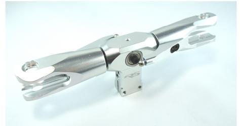
Kugelgelenk kann direkt in die Aufnahme eingedreht werden.
