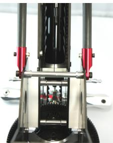
3. Setzen Sie den Chassisverbinder 9 ein und verschrauben Sie daran die Heckabstützungen. Die Schrauben werden erst nach dem endgültigen Ausrichten festgezogen.
