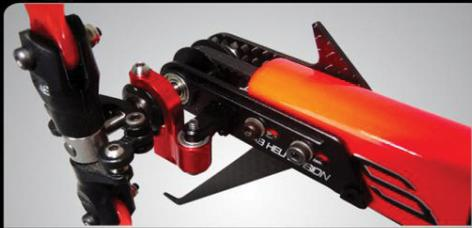
Optimierte Heckanlenkung für mehr Stabilität
