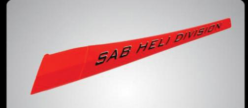
Carbon Heckausleger zur weiteren Reduzierung der Massen
