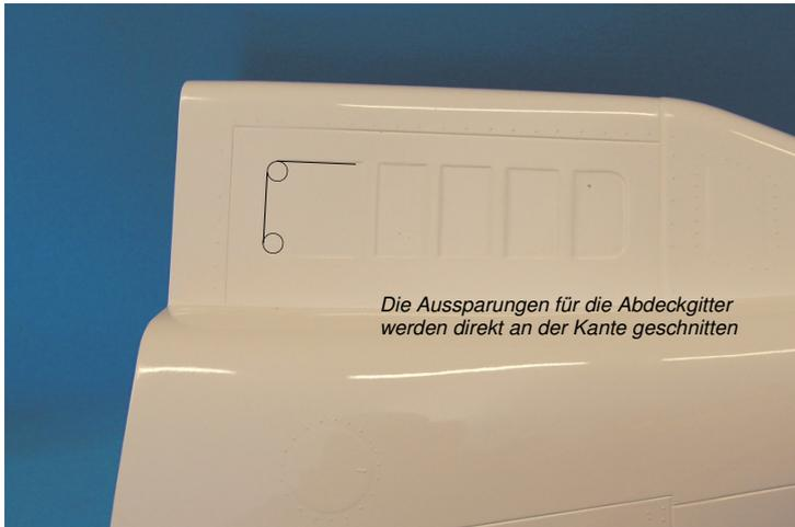
Die Aussparungen für die Abdeckgitter werden direkt an der Kante geschnitten
