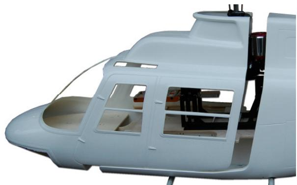
Setzen Sie nun das Rumpfvorderteil auf, und übertragen die jeweiligen Positionen der Bohrungen mit einem Filzschreiber. Anschließend können die Verbindungsdübel eingeharzt werden.
