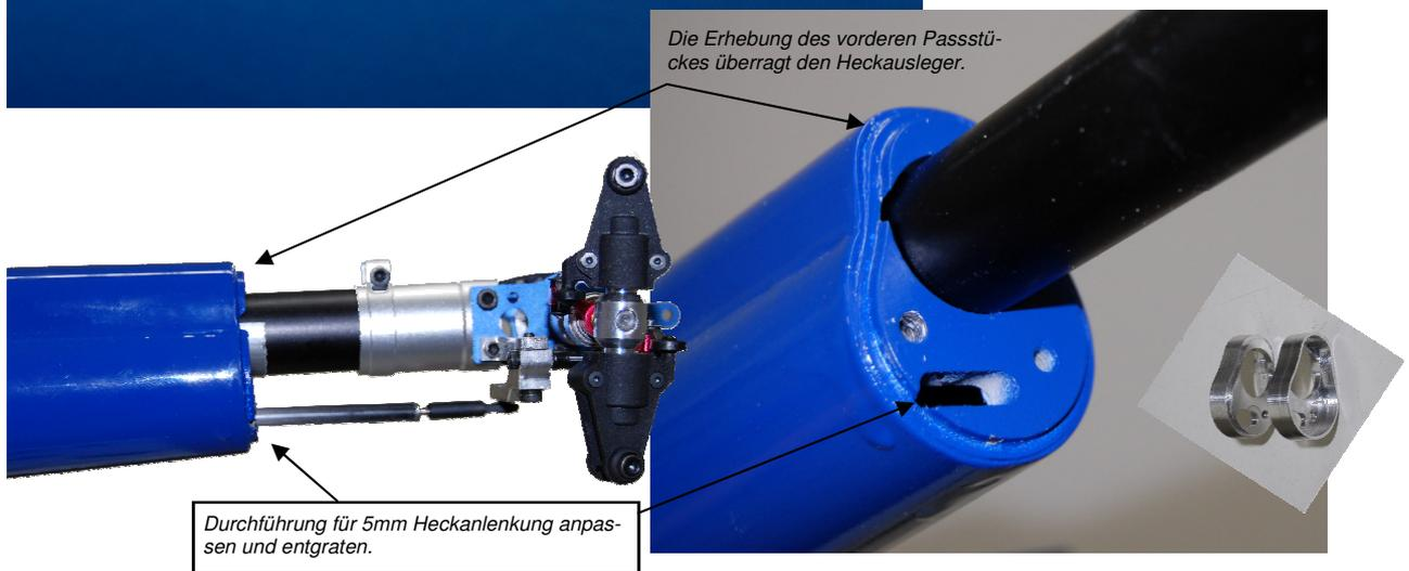
Durchführung für 5mm Heckenlenkung anpassen und entgraten.
