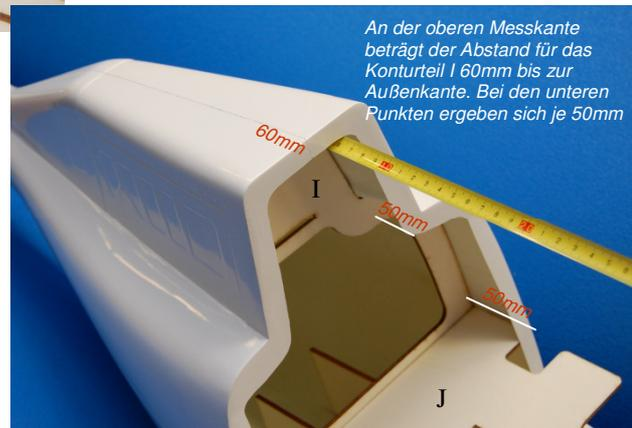
An der oberen Messkante beträgt der Abstand für das Konturteil I 60mm bis zur Außenkante. Bei den unteren Punkten ergeben sich je 50mm
