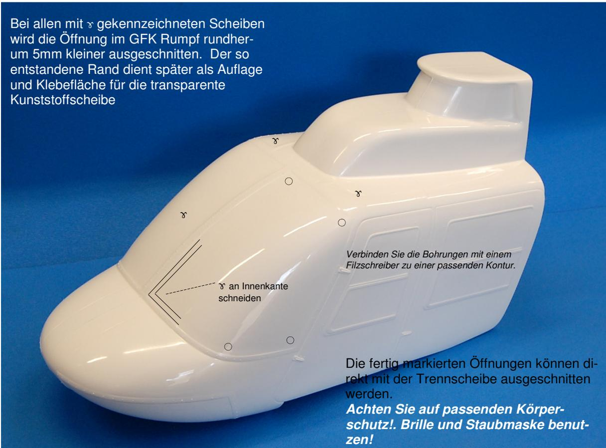
Die fertig markierten Öffnungen können direkt mit der Trennscheibe ausgeschnitten werden.
