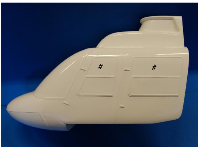
Die Seitenscheiben werden direkt an der jeweiligen Kante auf die beschriebene Weise ausgeschnitten. Hier werden die Scheiben (nach erfolgter Lackierung) von der Innenseite her eingeklebt.
