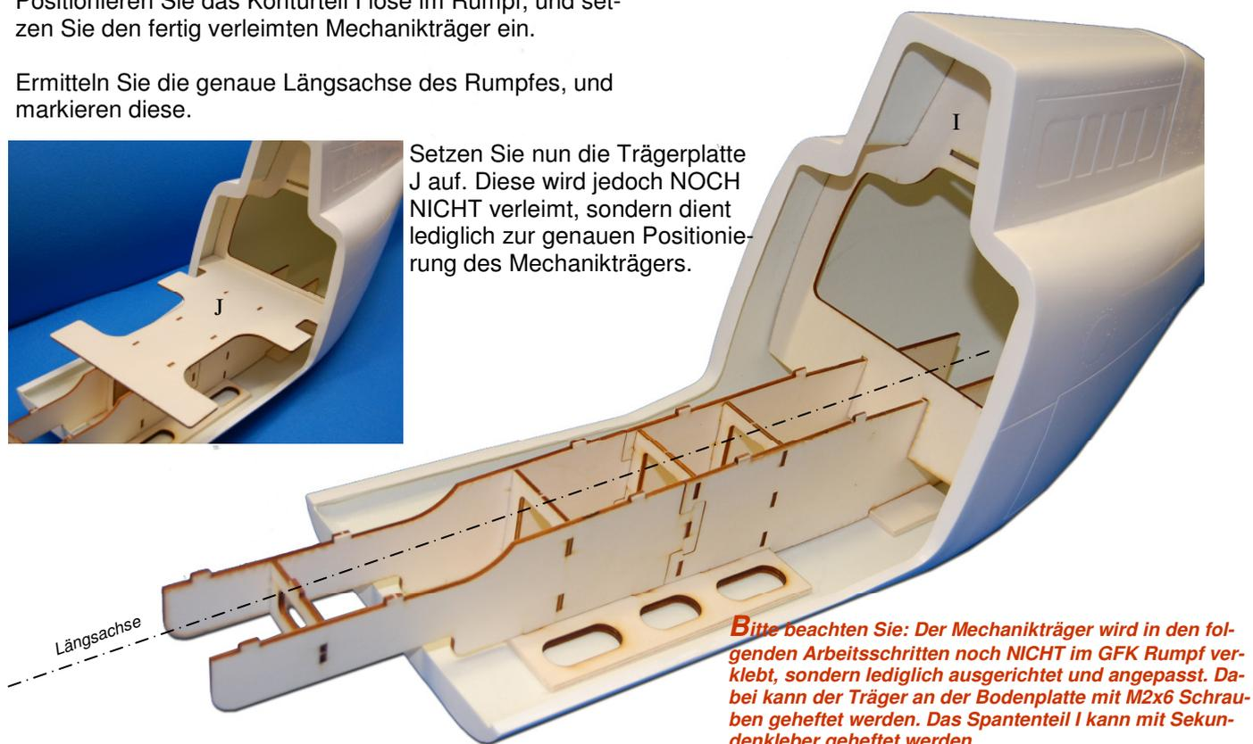
**Bitte beachten Sie:** Der Mechanikträger wird in den folgenden Arbeitsschritten noch NICHT im GFK Rumpf verklebt, sondern lediglich ausgerichtet und angepasst. Dabei kann der Träger an der Bodenplatte mit M2x6 Schrauben gefeftet werden. Das Spantenteil I kann mit Sekundenkleber gefeftet werden.
