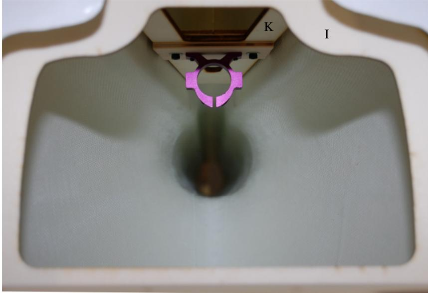
Der Spant K kann nun in das Formteil I eingesteckt werden. Die genaue Ausrichtung in der Horizontale nach hinten ergibt sich durch Einpassung der Mechanik.
