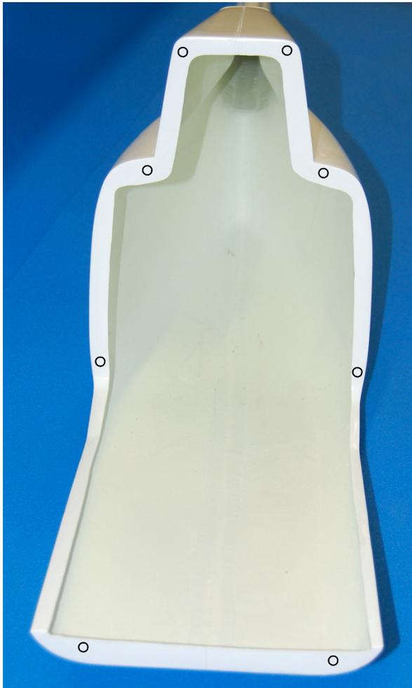
Bringen Sie an den links angezeigten Stellen je eine 6mm Bohrung an. In diese Bohrungen werden später die Hohlteile der Verbindungsdübel nach hinten weisend eingeklebt.
