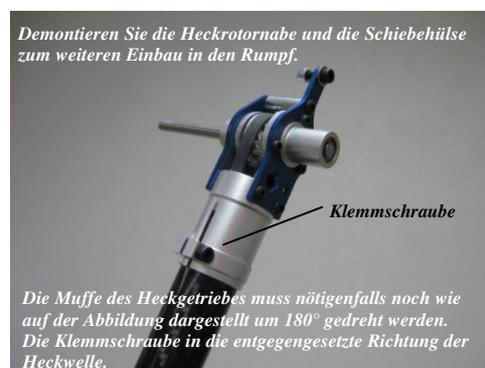
Demontieren Sie die Heckrotornabe und die Schiebehülse zum weiteren Einbau in den Rumpf.
