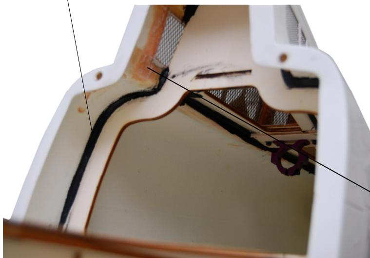
Glasfaserspachtel wird um die zu verklebenden Bauteile modelliert und dabei fest an den Untergrund angedrückt. Die extrem kurze Verarbeitungszeit ermöglicht einen sehr zügigen Baufortschritt. Nach der Aushärtung wird überschüssige Faserspachtel mit Schleifpapier P80 abgeschliffen. Dieser Vorgang kann auch maschinell erfolgen.
