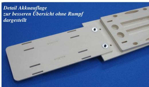
Wird die Cobra auch für leichten Kunstflug eingesetzt, so ist die Akkuauflage im vorderen Bereich durch eine Leiste abzufangen, welche auf die Innenseite des Rumpfes geklebt wird und verhindert, dass die Akkuauflage durch negative G-Kräfte nach oben ausweicht. Diese Leiste kann nach eigenem Ermessen eingebracht werden.
