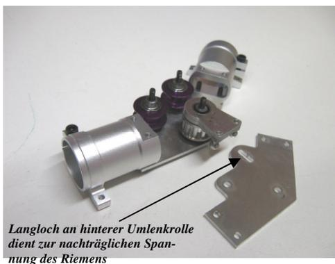
Langloch an hinterer Umlenkrolle dient zur nachträglichen Spannung des Riemens
