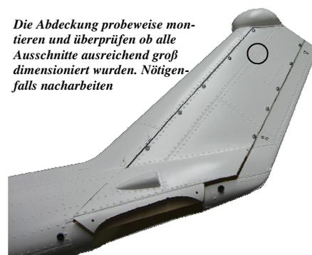
Die Abdeckung probeweise montieren und überprüfen ob alle Ausschnitte ausreichend groß dimensioniert wurden. Nötigenfalls nacharbeiten
