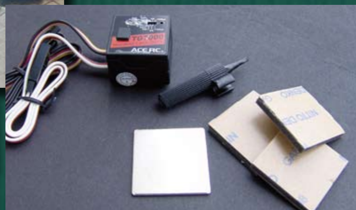
Bei der Montage von Gyro- oder Flybarless-Systemen sollte unbedingt das vom Hersteller jeweils favorisierte Doppelklebeband verwendet werden. Diese haben nämlich zum Teil aufgrund ihrer verschiedenen Materialbeschaffenheiten und Vibrationseigenschaften maßgeblichen Einfluss auf das Verhalten des mit Sensoren ausgestatteten Geräts
