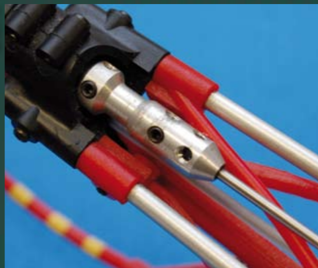
Auch bei schlecht gesicherten Zahnriemenrädern kann Schlupf entstehen, sofern diese durch eine Klemmverbindung auf der Welle gesichert werden. Vollständig schlupffrei sind nur versplintete Räder
