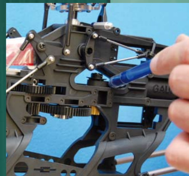
Wird trotz verschlissenen Antriebsritzels ein neues Hauptzahnrad montiert, entsteht auch dort dasselbe Tragbild. Dies gilt auch, wenn nacheinander verschiedene Zähnezahlen des Antriebsritzels montiert werden. Im Dauerbetrieb sollte also stets die Kombination verwendet werden. Nur so entsteht ein standfestes Tragbild, das in regelmäßigen Abständen kontrolliert werden sollte
