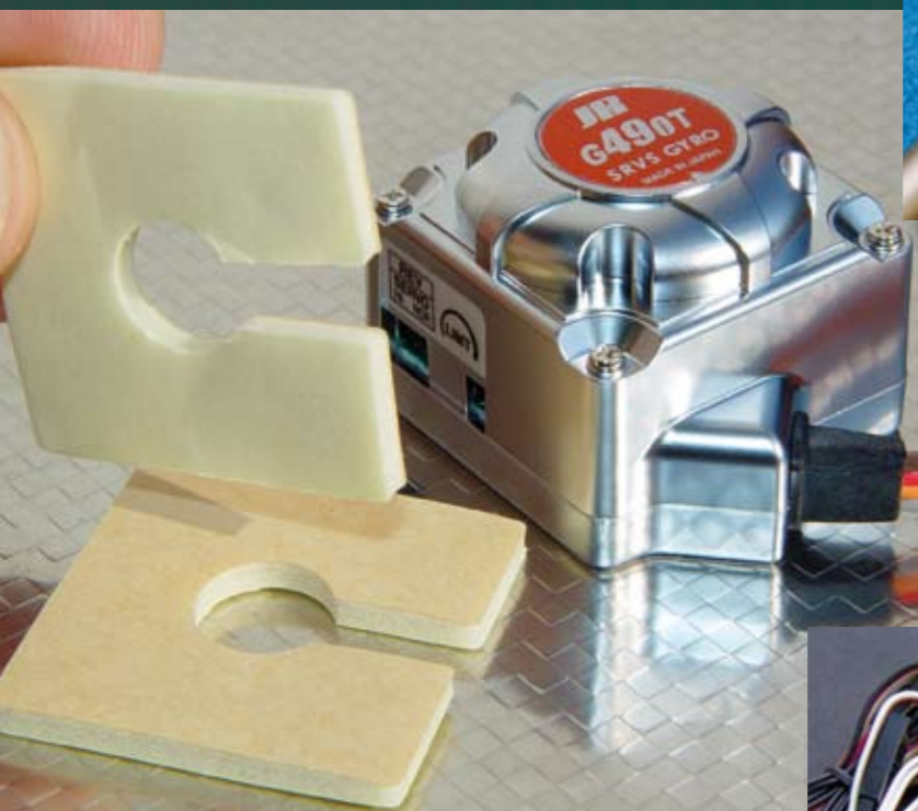
Bei der Montage von Gyro- oder Flybarless-Systemen sollte unbedingt das vom Hersteller jeweils favorisierte Doppelklebeband verwendet werden. Diese haben nämlich zum Teil aufgrund ihrer verschiedenen Materialbeschaffenheiten und Vibrationseigenschaften maßgeblichen Einfluss auf das Verhalten des mit Sensoren ausgestatteten Geräts
