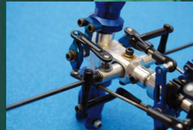
Graphitfarbiger Abrieb rund um Schrauben, Kugelbolzen oder andere Metallteile signalisiert unmissverständlich ein sich lösendes Bauteil. In einem derartigen Fall ist zuerst das Gewinde zu überprüfen. Erst danach kann das betreffende Bauteil unter Zugabe von flüssiger Schraubensicherung erneut montiert werden
