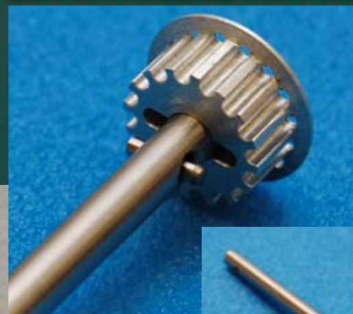
Auch bei schlecht gesicherten Zahnriemenrädern kann Schlupf entstehen, sofern diese durch eine Klemmverbindung auf der Welle gesichert werden. Vollständig schlupffrei sind nur versplintete Räder
