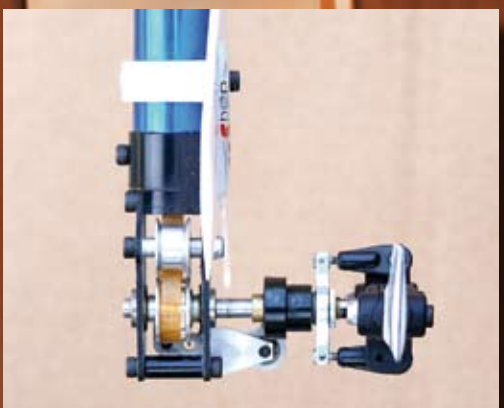
Heckrotorausschlag bei Sender-Kommando Autorotation: Der Heckrotor zeigt null Grad Einstellwinkel, gleichbedeutend keinen Schub. Diese Grundposition wird nur während der Autorotation benötigt (kein Drehmoment vorhanden), wenn das Gyro-System nicht im Heading-Lock-Modus betrieben wird
