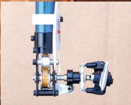
Heckrotorausschlag bei Heckrotor-Neutralstellung: Hier ist deutlich der in Servomitte ständig anliegende Grundschub entgegen Drehmoment zu erkennen
