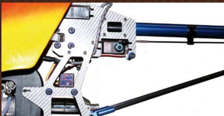
Bild 2: Der Pilot sollte unbedingt darauf achten, dass die Heckrotor-Anlenkung nicht federt und möglichst wenig Spiel hat. Eine ordentlich geführte Schubstange und der passende Einbauort für das Gyro-System und das Heckrotorservo sind von entscheidender Bedeutung für die Qualität der maximal erreichbaren Heckstabilisierung
