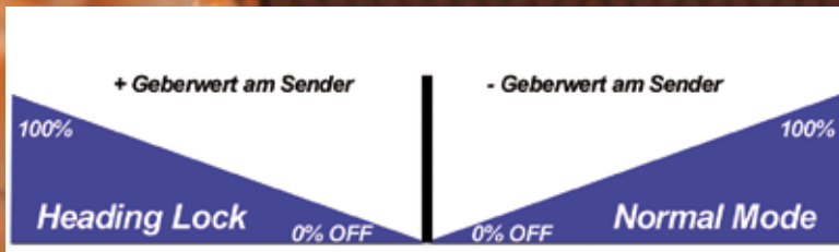
Bild 1: Die beiden blauen Balken symbolisieren den vollen senderseitigen Geberwert des Zusatzkanals, der die Empfindlichkeit des Gyro-Systems steuert. In Gebermitte ist das Gyro-System inaktiv. Wird der Geberwert beispielsweise in Richtung Minus erhöht, stellt sich eine zunehmende Empfindlichkeit im Normal-Modus ein. Wird hingegen in Richtung Plus erhöht, so wird eine zunehmende Empfindlichkeit im Heading-Lock-Modus aktiviert
