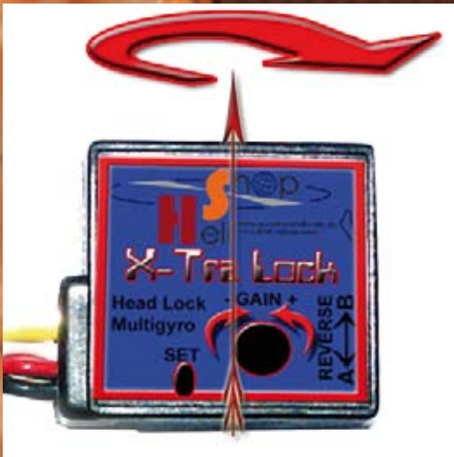
Abbildung 4 zeigt die Sensorachse des Gyro-Systems. Um einwandfreies Arbeiten der Elektronik zu gewährleisten, muss das Gerät so im Hubschrauber eingebaut werden, dass die Sensorachse absolut parallel zur Hauptrotorwelle verläuft
