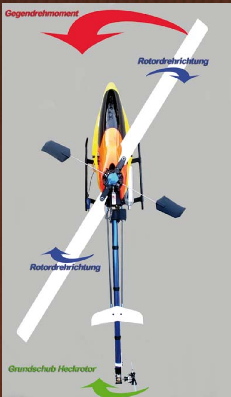
Abbildung 3: Die blauen Pfeile geben die Rotordrehrichtung an, während der rote Pfeil das entstehende Gegendrehmoment symbolisiert. Der grüne Pfeil steht für den Heckrotor-Grundscharb. Dieser liegt in Neutralstellung des Heckrotors an, um den Gegendrehmoment des Hauptrotors entgegen zu wirken.
