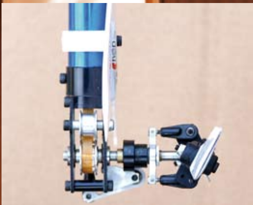
Heckrotorausschlag bei Steuerknüppel-Kommando Heckrotor rechts: Der Heckrotor steuert die Nase des Modell nach rechts, erzeugt also eine Drehung des Hubschraubers im Uhrzeigersinn.
